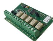
Modulo di espansione auxi relè con 5 uscite relè programmabili
