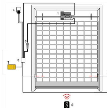
1. Motore 2. Trasmettitore 3. Fotocellule 4. Luce lampeggiante 5. Centrale di comando 6. Selettore a chiave o digitale 7. Display multifunzione O-View
