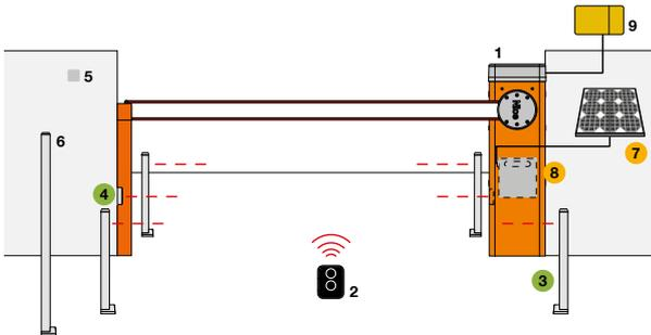
1. Motore 2. Trasmettitore 3. Fotocellule a colonna 4. Fotocellule 5. Selettore a chiave o digitale 6. Selettore a chiave o digitale su colonna 7. Pannello solare SYP 8. Box batteria PSY24 9. Interfaccia multifunzione Pro-View
