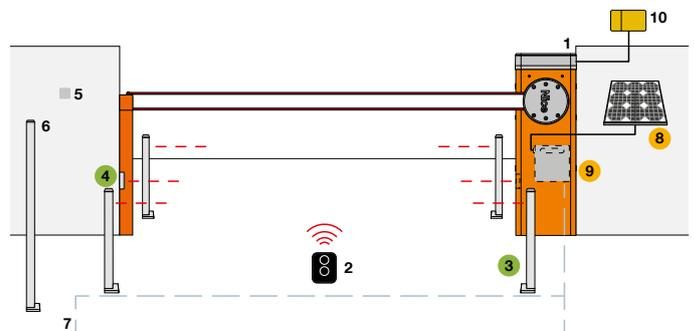
1. Motore 2. Trasmettitore 3. Fotocellule a colonna 4. Fotocellule 5. Selettore a chiave o digitale 6. Selettore a chiave o digitale su colonna 7. Loop detector 8. Pannello solare SYP 9. Box batteria PSY24 10. Interfaccia multifunzione Pro-View
