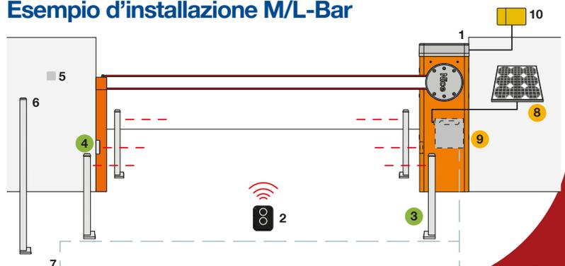
1. Motore 2. Trasmettitore 3. Fotocelle a colonna 4. Fotocelle
