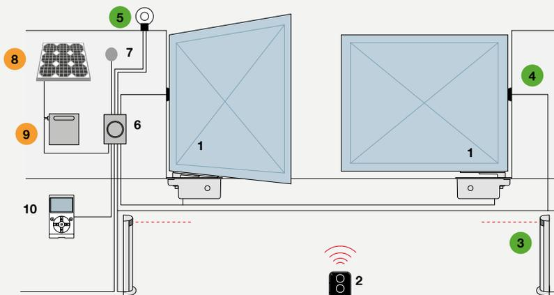
1. Motore; 2. Trasmettitore; 3. Colonnine; 4. Fotocellule; 5. Luce lampeggiante
