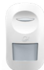
Rivelatore filare volumetrico infrarosso destinato ad un uso professionale e civile. Area di copertura massima 12 m per 90°. Antimask attivo sulla sezione IR per acceccamento a contatto su lente. Resistenze di fine linea integrate selezionabili tramite jumper. Configurazione parametri tramite dip-switch. Dimensioni (L x H x P in mm): 64 x 116 x 48.
