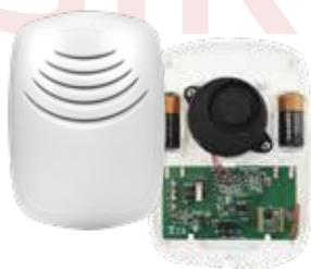
Mini Sirya PRO, sirena wireless indoor **alimentata a batteria**. Resa sonora 101 db (A) a 1 m. Morsetto aggiuntivo per alimentazione a 12Vcc. Protezione tamper antiapertura/antistrappo. Tempo di ricezione allarme in meno di 1 secondo. 2 Batteria a litio 3V CR123 (in dotazione). Configurazione del tono su 8 disponibili, configurazione del volume su tre livelli (basso, medio, alto). Programmazione tecnica da software CombiTEC. Dimensioni (L x H x P in mm): 117 x 157 x 54.
