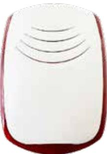
Sirena autoalimentata da esterno stand-alone per il collegamento a qualsiasi centrale di allarme. Lampeggiante led ad alta luminosità. Contenitore in ASA bianco (stabilità alle alte temperature, elevata resistenza ai raggi UV e agli agenti atmosferici e chimici) e lampeggiante in policarbonato rosso.
