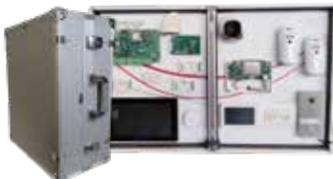
La valigia contiene: centrale LTE, modulo LTE, modulo PSTN, moduli domotici, tastiere, inseritore prox con modulo audio, sonda di temperatura, ricevitore 868 MHz, rivelatori indoor e outdoor (wireless, convenzionali o BUS), radiocomando, chiavi di prossimità, telecamera, switch Wi-Fi per collegamenti WLAN al sistema, alimentazione a 220V. La valigia è customizzabile su richiesta.
