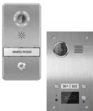
Posto esterno videocitofonico IP per la gestione delle chiamate videocitofoniche direttamente da una o più tastiere Simplya Video III (vers. FW compatibile). Telecamera da 1 Mpx con led per visione notturna, utilizzabile anche per funzioni di Videosorveglianza. Pulsante apriporta (magnetica/elettrica). Lettore card reader per apertura porta. Alimentazione a 12V e POE. In acciaio (IP55).
